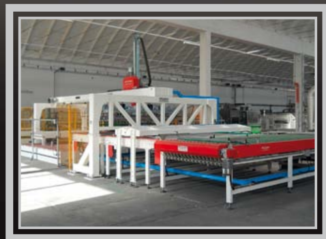
Sistema automatico di carico/scarico linea di taglio e squadratura per lastre di grande formato ( dal 250x250 al 1600x3600 mm) System for the automatic loading/unloading of a cutting and squaring line for large sizes ( from 250x250 to 1600x3600 mm)
