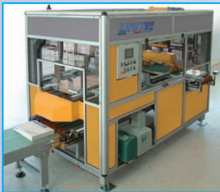
UNITA' DI CONFEZIONAMENTO PER PIASTRELLE SU RETE IN CARTA/FIBRA/DOT MOUNTING UNITS' PACKAGING FOR TILES ON NETPAPER / NETFIBER / DOT MOUNTING
