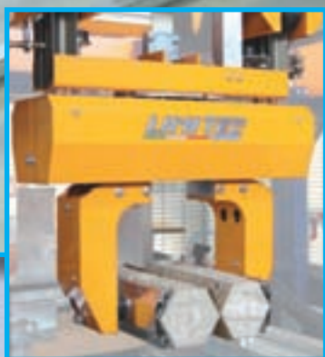
UNITA' DI SMISTAMENTO E CONFEZIONAMENTO PER PEZZI SPECIALI UNITS' SORTING AND PACKAGING FOR SPECIAL PIECES
