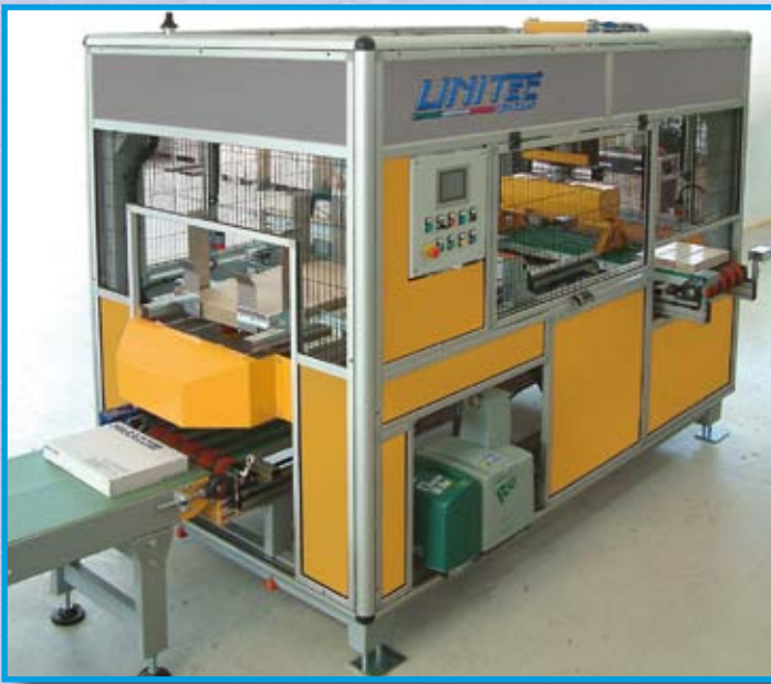
UNITA' DI CONFEZIONAMENTO PER PIASTRELLE SU RETE IN CARTA/FIBRA/DOT MOUNTING UNITS' PACKAGING FOR TILES ON NETPAPER / NETFIBER / DOT MOUNTING
