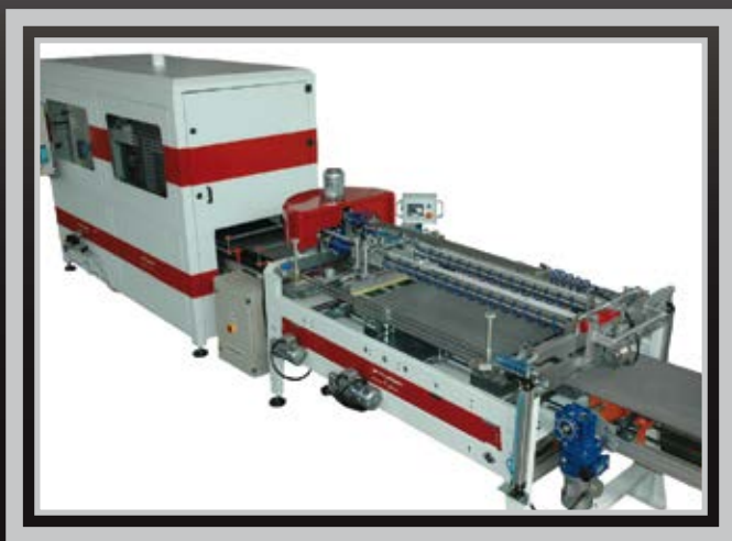
Linea di serigrafia per decoro su grandi formati (600x1200 mm e oltre) Screen printing line for decoration on big sizes (600x1200 mm and over)
