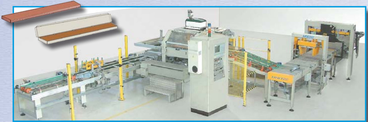
UNITA' DI SMISTAMENTO E CONFEZIONAMENTO PER LISTONI E FORMATI SPECIALI UNITS' SORTING AND PACKAGING BOARDS AND SPECIAL SIZE
