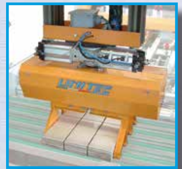
UNITÀ DI SMISTAMENTO E CONFEZIONAMENTO PER PEZZI SPECIALI UNITS' SORTING AND PACKAGING FOR SPECIAL PIECES
