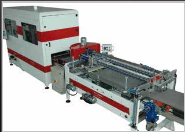
Linea di serigrafia per decoro su grandi formati (600x1200 mm e oltre) Screen printing line for decoration on big sizes (600x1200 mm and over)
