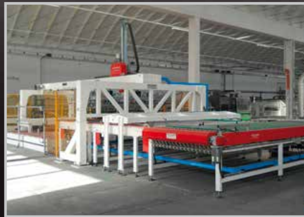
Sistema automatico di carico/scarico linea di taglio e squadratura per lastre di grande formato (dal 250x250 al 1600x3600 mm) System for the automatic loading/unloading of a cutting and squaring line for large sizes (from 250x250 to 1600x3600 mm)
