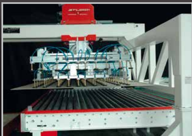
Organo di presa a ventose per formato 1600x3600 mm Handling unit with vacuum cusps for size 1600x3600 mm
