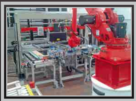
ISOLA ROBOTIZZATA per la movimentazione, alimentazione, stoccaggio. Sistema di riconoscimento pallet tramite scanner in 3D ROBOTIZED ISLAND for ceramic handling, feeding, storage. Pallet recognition system through 3D scanner
