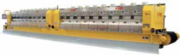
dedicati alle fasi di trattamento, implementate ulteriormente da macchine a satelliti per l'applicazione dei fluidi a residuo permanente. La soluzione dei satelliti brandeggianti consente una stesura ottimale dei prodotti su tutta la superficie della piastrella.
