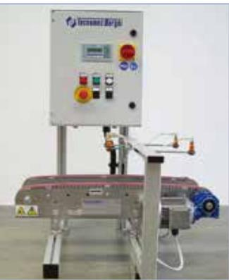
girello e pareggiatore in un'unica macchina. L'ingombro ridotto e la gestione software permettono di girare piastrelle di grandi formati in poco spazio anche alle alte velocità, inoltre grazie alla funzione pareggiatore, la mattonella girata risulterà sempre dritta indipendentemente da come arriva. Prodotto in due versioni di lunghezza è in grado di girare
