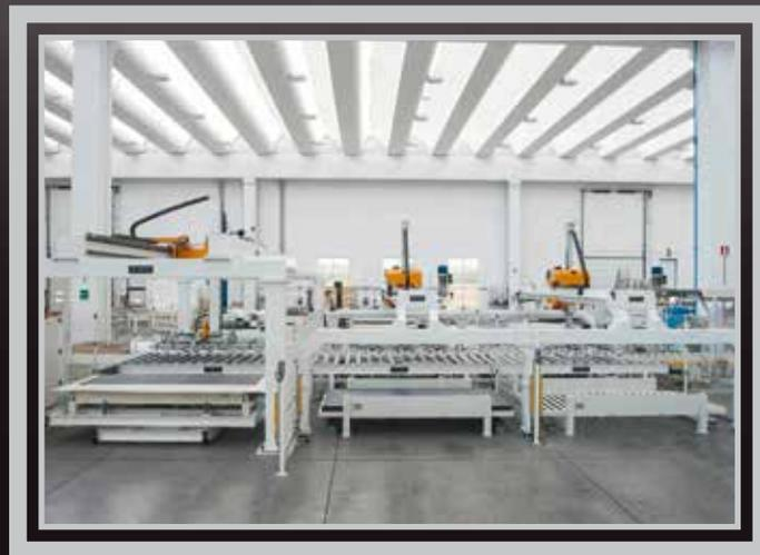
Sistema automatico di scarico linea di pre - scelta per grandi formati con possibilità di stoccaggio orizzontale su pianali o stoccaggio verticali su trespoli.
