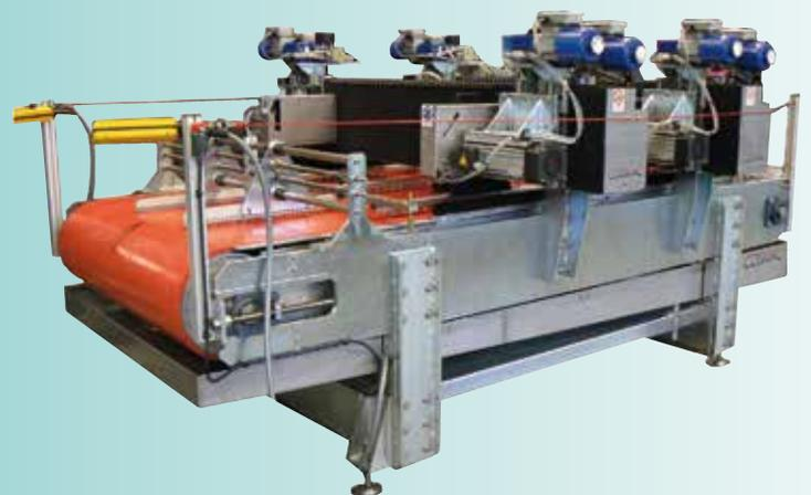
MACCHINA DA TAGLIO CON POSIZIONAMENTO DISCHI AUTOMATICO
