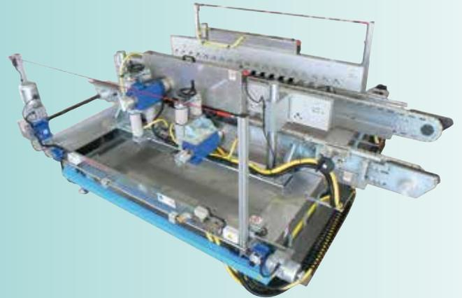
RIFILATRICE A DISCHI DIAMANTATI PER LASTRE
