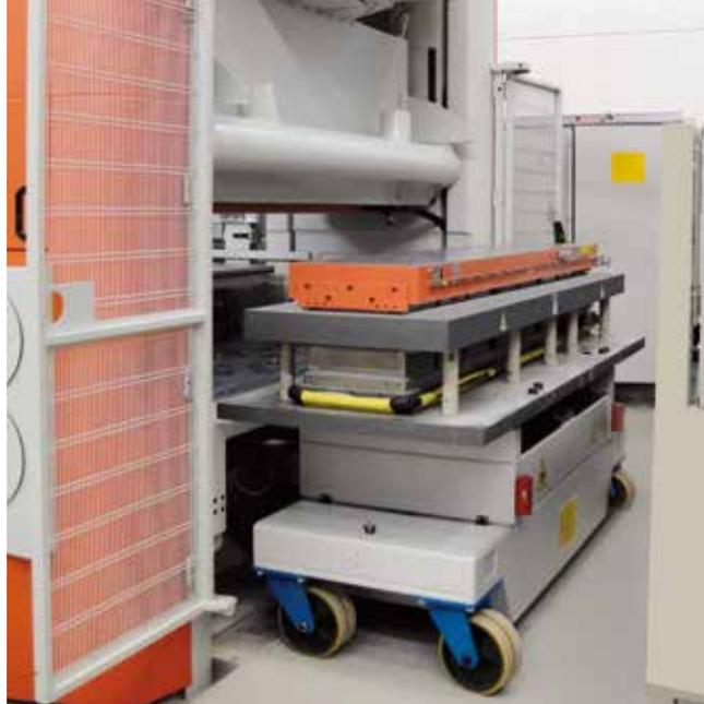
Con il sistema di Cambio Rapido Stampo (CRS) di Sacmi, il sogno della produzione just in time in ceramica diventa realtà. Flessibilità, ma anche riduzione della manodopera e degli spazi necessari: queste le caratteristiche distintive della soluzione, lanciata in occasione di Tecnargilla 2010 per la pressa PH3200 e presto estesa a tutte le presse della gamma con luce libera tra le colonne pari a 2.450 mm (PH3800, PH5000XXL, PH6500, PH7500, PH10000).
