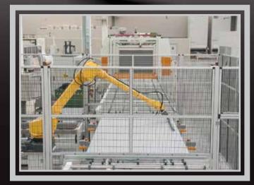
Robot di stesura resina per applicazione stuoia, stazione di spatolatura e fissaggio rete di rinforzo. Robot 'Fanuc Long Arm' completi di basamento, organo di presa con innesto rapido a baionetta, magazzino porta utensili con tre spatole di servizio, trasporto speciale con sistema auto centrante per il prodotto.
