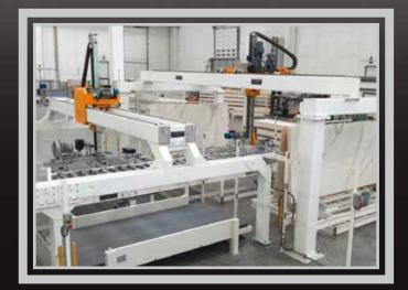
Sistema automatico di scarico grandi formati con possibilità di stoccaggio orizzontale su pianali o stoccaggio verticale su trespolo. La macchina è in grado di manipolare formati fino a 1600x3200 mm, spessore 20 mm. Il sistema è equipaggiato con piattaforme rotanti per il cambio stoccaggio.
