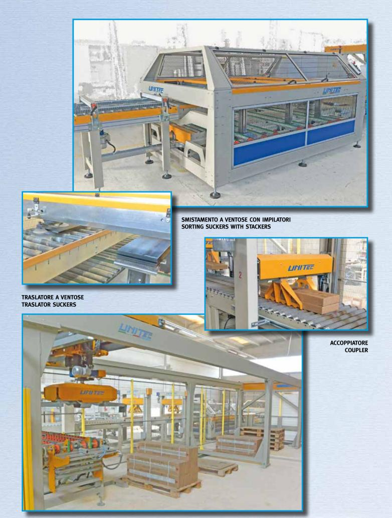
SISTEMI DI PALLETTIZZAZIONE E FINE LINEA PERSONALIZZATI CUSTOMIZED END-OF-LINE PALLETIZATION SYSTEMS
