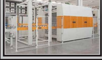
Essiccatoio verticale per grandi lastre, formato fino a 1600x3200, spessore 20 mm. L'unità è completa di elevatore in ingresso e discensore in uscita per l'asservimento al carico ed allo scarico dello stesso.
