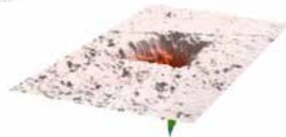
Immagine 3D a scala di colori in micron di pori presente sulla superficie del campione
