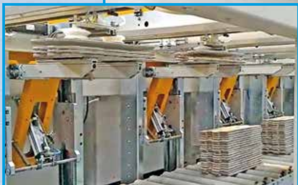
IMPILATORE CON TRASLATORE A VENTOSE VELOCE STACKER WITH RAPID SUCTION TRANSLATOR
