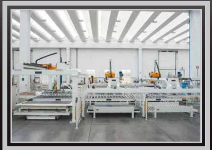
Sistema automatico di scarico linea di pre - scelta per grandi formati con possibilità di stoccaggio orizzontale su pianali o stoccaggio verticali su trespoli.
