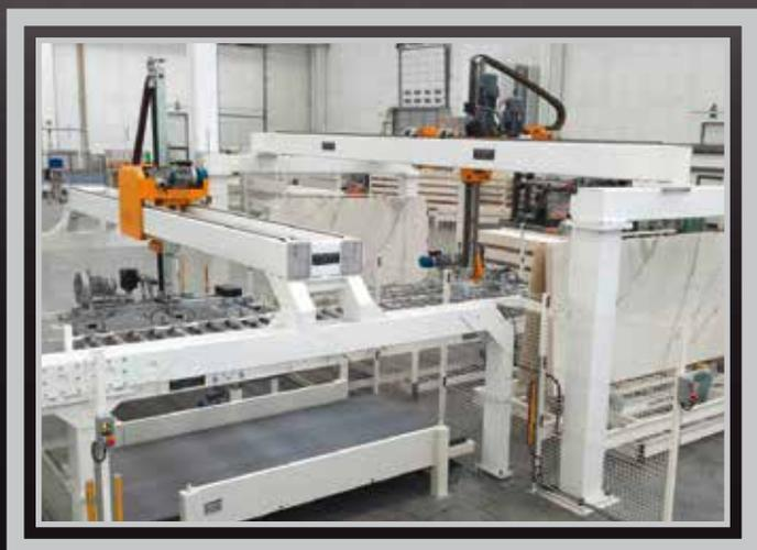
Sistema automatico di scarico grandi formati con possibilità di stoccaggio orizzontale su pianali o stoccaggio verticale su trespolo. La macchina è in grado di manipolare formati fino a 1600x3200 mm, spessore 20 mm. Il sistema è equipaggiato con piattaforme rotanti per il cambio stoccaggio.
