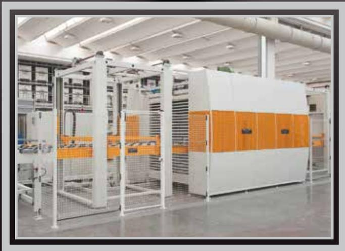
Essiccatoio verticale per grandi lastre, formato fino a 1600x3200, spessore 20 mm. L'unità è completa di elevatore in ingresso e discensore in uscita per l'asservimento al carico ed allo scarico dello stesso.
