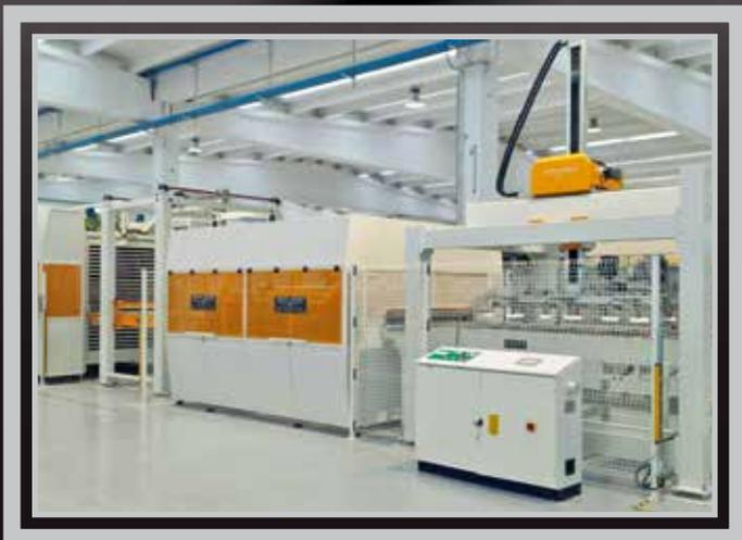
Scarico linea per grandi lastre completo di essiccatoio verticale con carico e scarico automatico, ribaltatore assiale, portale di scarico a tre postazioni.
