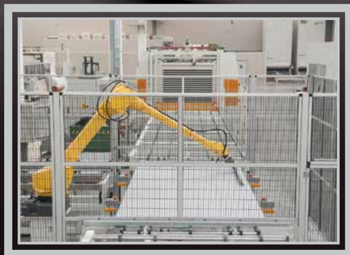
Particolare Robot di stesura resina su linea di applicazione stuoia. Linea completamente automatica per applicazione stuoia. La stuoia applicata alla lastra garantisce un'incremento della resistenza meccanica nei valori di flessione e resilienza di circa un 30% e viene applicata inoltre per garantirne la sicurezza nell'uso della lastra in determinati contesti.
