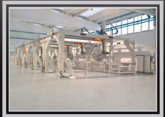
Impianto automatico di scarico scelta per lastre adatto alla gestione sia dei contenitori metallici che delle casse che delle cavallette con sistema di finitura integrato idoneo anche alla funzione di PICKING per la preparazione dell'ordine pronto per la spedizione. Formati fino a 1800x3600 mm, spessore da 3 a 30 mm.
