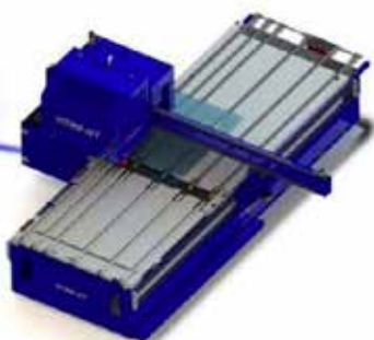
Sistema di posizionamento automatico laterale
