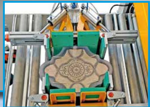
UNITÀ DI COMPATTAMENTO PILE PILES COMPACTING UNIT
