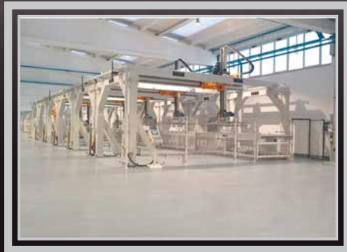
Impianto automatico di scarico scelta per lastre adatto alla gestione sia dei contenitori metallici che delle casse che delle cavallette con sistema di finitura integrato idoneo anche alla funzione di PICKING per la preparazione dell'ordine pronto per la spedizione. Formati fino a 1800x3600 mm, spessore da 3 a 30 mm.
