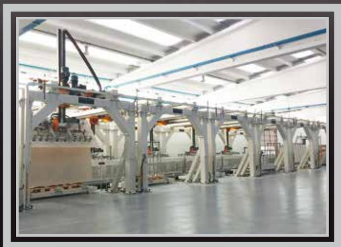
Sistema automatico di scarico lastre per formati fino a 1800x3600 mm spessore fino a 30 mm in grado di gestire lo stoccaggio in casse, in contenitori metallici o cavallette verticali.
