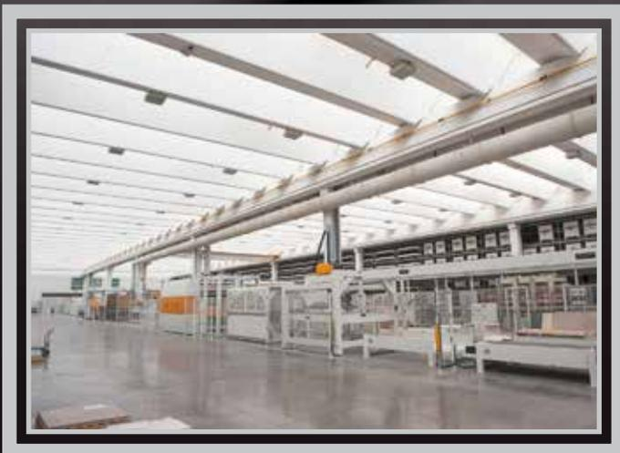
**LINEA RESINATURA E APPLICAZIONE STUOIA** . Linea completamente automatica per applicazione stuoia. La stuoia applicata alla lastra garantisce un'incremento della resistenza meccanica nei valori di flessione e resilienza di circa un 30% e viene applicata inoltre per garantirne la sicurezza nell'uso della lastra in determinati contesti.
