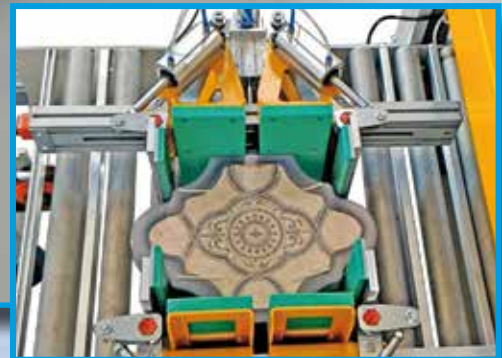
UNITÀ DI COMPATTAMENTO PILE PILES COMPACTING UNIT
