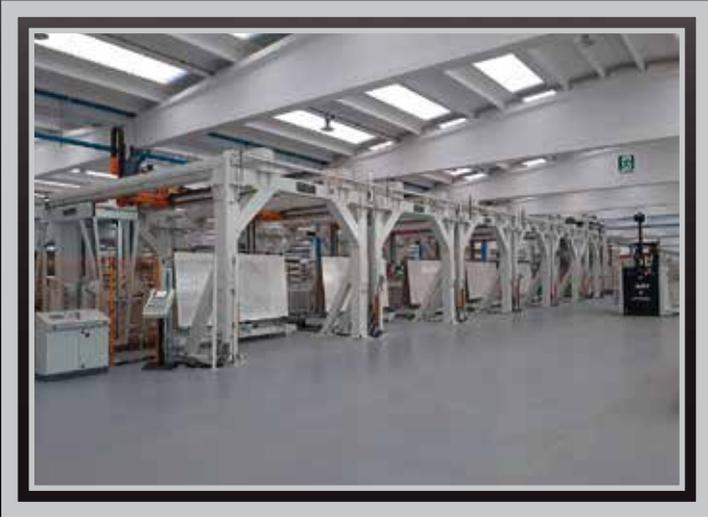
SISTEMA AUTOMATICO SCARICO LASTRE per formati fino a 1800x3600 mm spessore fino a 30 mm in grado di gestire lo stoccaggio in casse, in contenitori metallici o cavallette verticali.
