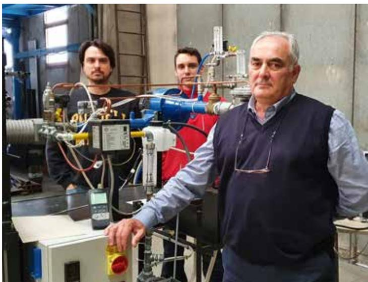
viamente opportunamente modificato per potere gestire l'idrogeno che in combustione ha velocità di propagazione altissima (7 volte superiori al metano) – oltre che per contenere e o possibilmente diminuire la formazione di ossidi di azoto (NOX), onnipresenti nelle combustioni di gas metano e aria. L'unità di controllo garantisce, infine, mediante il rilevamento continuo dei parametri fisici di processo, il funzionamento ottimale del dis-
