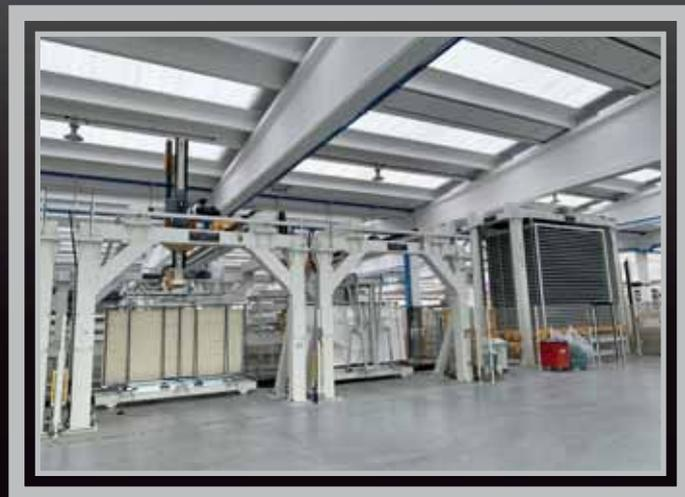
**IMPIANTO AUTOMATICO DI SCARICO SCELTA** per lastre adatto alla gestione sia dei contenitori metallici che delle casse che delle cavallette con sistema di nitura integrato idoneo anche alla funzione di PICKING per la preparazione dell'ordine pronto per la spedizione . Formati no a 1800x3600 mm spessore da 3 a 30 mm.
