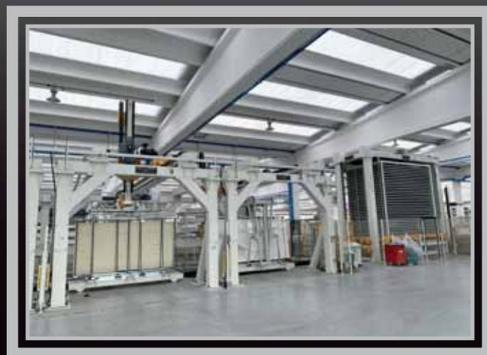
**IMPIANTO AUTOMATICO DI SCARICO SCELTA** per lastre adatto alla gestione sia dei contenitori metallici che delle casse e delle cavallette con sistema di nitura integrato idoneo anche alla funzione di PICKING per la preparazione dell'ordine pronto per la spedizione . Formati no a 1800x3600 mm spessore da 3 a 30 mm.
