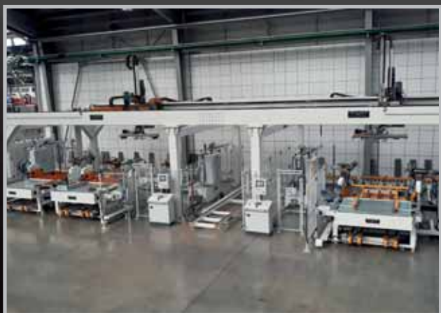
SISTEMA AUTOMATICO 'PICKING' GRANDI FORMATI - gestione pallettizzazione scatole con formatura in orizzontale/verticale ad alte prestazioni.
