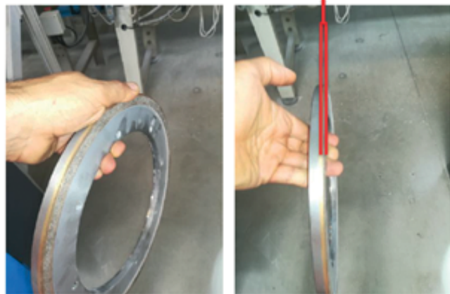
MOLE CONSUMATE DALLE SQUADRATRICI CON TELECAMERE DI MISURAZIONE
