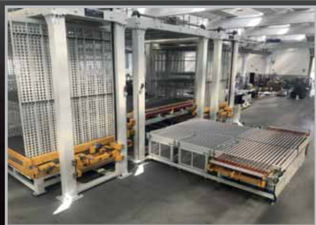
BUFFER - Sistemi automatici di polmonatura al carico forno disponibili per diverse capacità, diversi formati e spessori in base alle esigenze produttive.
