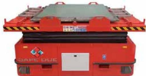
Il carrello motorizzato è stato realizzato per il prelievo, trasporto e deposito dei tamponi superiori e inferiori per stampi destinati alla pressatura a secco di piastrelle ceramiche.
