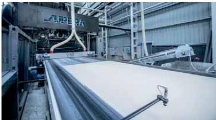
o umidità, disponibili a KM 0, comportando costi operativi tra i più contenuti sul mercato e abbattendo i costi produttivi annui del 50%. Revigrés ha inoltre scelto di equipaggiare SUPERA® RAPIDA con il sistema brevettato Start&Stop®, innovativa centralina idraulica con pompe modulabili in base al ciclo di pressatura, per sostenere minimi consumi
