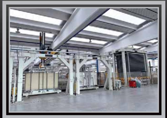
**IMPIANTO AUTOMATICO DI SCARICO SCELTA** per lastre adatto alla gestione sia dei contenitori metallici che delle casse che delle cavallette con sistema di nitura integrato idoneo anche alla funzione di PICKING per la preparazione dell'ordine pronto per la spedizione . Formati no a 1800x3600 mm spessore da 3 a 30 mm.
