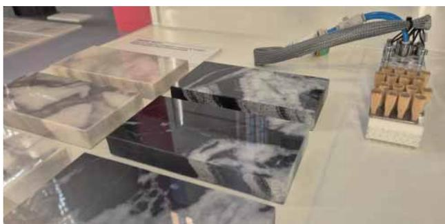
nell'alto di gamma di effettuare una decorazione tridimensionale a tutta massa, con controllo digitale dello scarico delle polveri atomizzate colorate nei diversi punti scelti della lastra, a seconda della grafica impostata. Grazie a un sistema di testine per polveri senza organi di movimento, garantisce affidabilità e precisione lavorando all'interno della massa del prodotto per realizzare così effetti materici di altissimo livello
