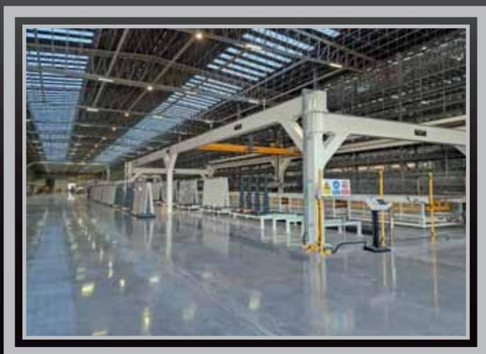
LINEA DI SCELTA LASTRE per lo stoccaggio in casse, panconi, trespoli (L + A Frame) integrato con sistema di finitura idoneo anche alla funzione di PICKING per la preparazione dell'ordine pronto per la spedizione.
