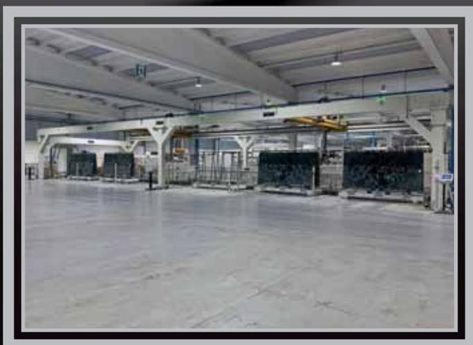
PORTALE A 4 ASSI DI SCARICO LINEA AD ALTE PRESTAZIONI, DOTATO DI DOPPIO CARRO INDIPENDENTE - 6 postazioni per stoccaggio lastre in orizzontale o verticale, idoneo anche alla funzione di PICKING per la preparazione di ordini multi-referenza, all'interno del portale è possibile integrare il sistema di reggiatura ed il sistema automatico di tamponatura casse tramite 'foam bag' auto espandibili.
