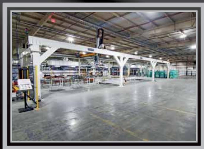
LINEA DI SCELTA 'IBRIDA' A TESTE INTERCAMBIABILI, CON ORGANO DI PRESA PER SCATOLE / INTERFALDA E ORGANO DI PRESA TELESCOPICO A VENTOSE PER LASTRE E LISTONI / INTERFALDA. Linea di scelta multi funzione per la gestione di diverse tipologie di stoccaggio tramite l'utilizzo di un solo portale dotato di organi di presa intercambiabili in automatico per la palletizzazione di scatole, lo stoccaggio di lastre in UDC orizzontali/verticali e la gestione di listoni.
