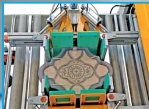
UNITÀ DI COMPATTAMENTO PILE PILES COMPACTING UNIT
